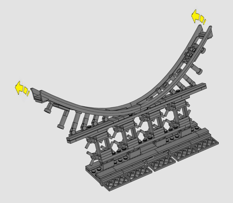
Die Bögen zwischen den Beinen des Eiffelturms sind keine tragenden Elemente, sondern dienen nur ästhetischen Zwecken. Auch beim LEGO\* Modell sind die Bögen reine Zierelemente.
